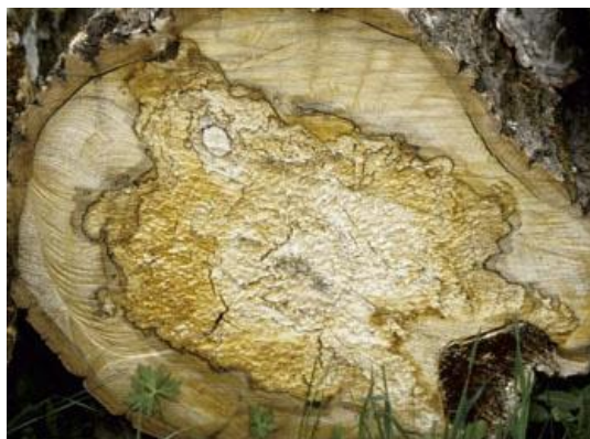
Figura 7. Tronco cortado con ataque de pudrición blanca producida por Trametes versicolor (Fuente: Red Demon, 2012).
