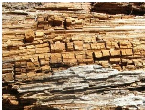
Figura 3: Madera de pino Insigne con presencia de pudrición parda (Fuente: Shaner et al. , 1999).
